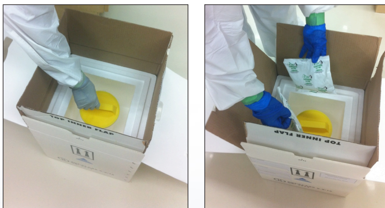
รูปที่ 2 การขนส่งตัวอย่างพร้อมสารทำความเย็น
